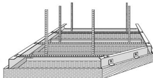
Im Außenbereich werden die Einhängewinkel und Streckmetallelemente aus Aluminium gefertigt und die Abhänger mit einem Korrosionsschutzlack C4 versehen. Weiterhin werden mit Sturmsicherungsbügel (siehe Foto unten) die Streckmetallkassetten gesichert.
