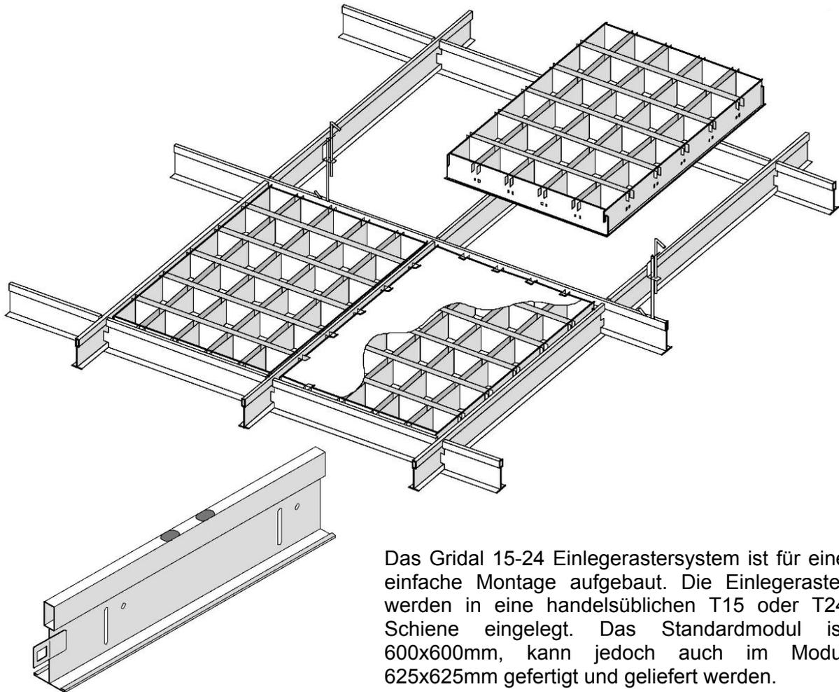
Das Gridal 15-24 Einlegerastersystem ist für eine einfache Montage aufgebaut. Die Einlegeraster werden in eine handelsüblichen T15 oder T24 Schiene eingelegt. Das Standardmodul ist 600x600mm, kann jedoch auch im Modul 625x625mm gefertigt und geliefert werden.
