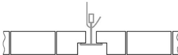
Die Lichtrasterdecken (Quadro und Diagonal) können wie oben dargestellt mit verdeckt liegender Unterkonstruktion abgehängt werden. Die einzelnen Rasterelemente werden mittels Haken-Clipse verbunden. Alternativ ist auch eine Einlegemontage bündig und verdeckt (linke Bilder) möglich.
