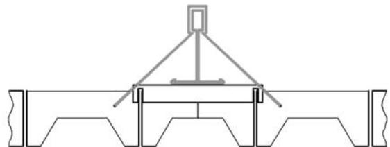
Die Design-Rasterdecken (Cristal, Cubus, Rubin und Safir) werden wie bildlich dargestellt mit verdeckt liegender Unterkonstruktion abgehängt. Die einzelnen Rasterelemente werden mittels Haken-Clipse verbunden.
